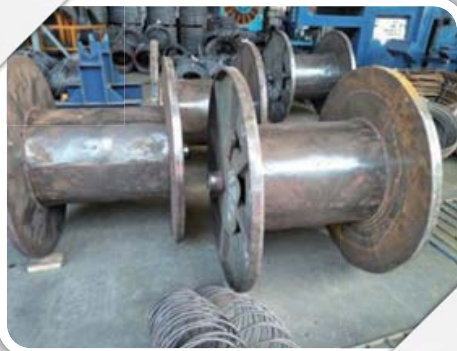
圖說: 預鑄工廠鋼筋滾輪未設輪擋
