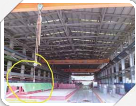
圖說: 預鑄工廠遙控器施作後未及時歸位
